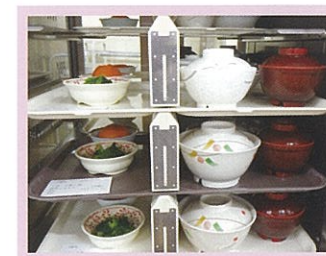
仕切りの右側は温かく、左側は冷たく保つことができます。
